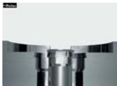
L'estremità del tubo viene rilasciata e può essere estratta dalla macchina
