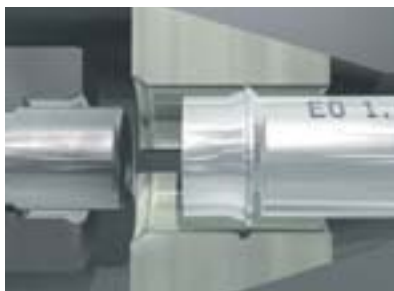
L'estremità del tubo viene rilasciata ed è pronta per attaccare la guarnizione EO-2
