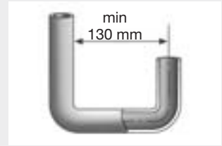
● Minimo spazio di curvatura a „U“
