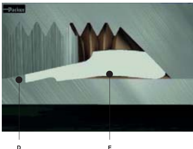
Un corretto risultato di assemblaggio si ottiene con 1 giro \frac{1}{2} del dado.
