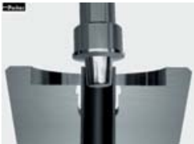
Mentre si muove, il punzone frontale espande la parete del tubo dall'interno
