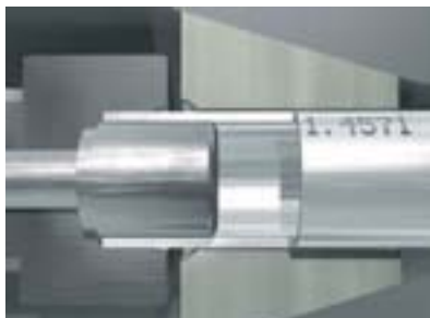
Il tubo viene inserito nelle apparecchiature fino a che non tocca saldamente l'arresto all'estremità
