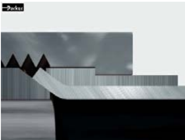
Dopo il serraggio del tubo
