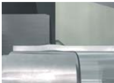
Mentre si muove, il punzone esegue la formatura in continuo della parete del tubo comprimendo il materiale
