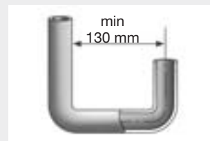
● Minimo spazio di curvatura a „U“
