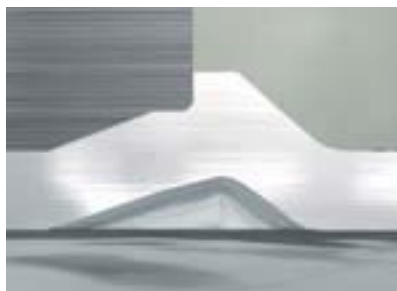
Non appena il punzone in movimento tocca le ganasce di chiusura, il processo di formatura è completo
