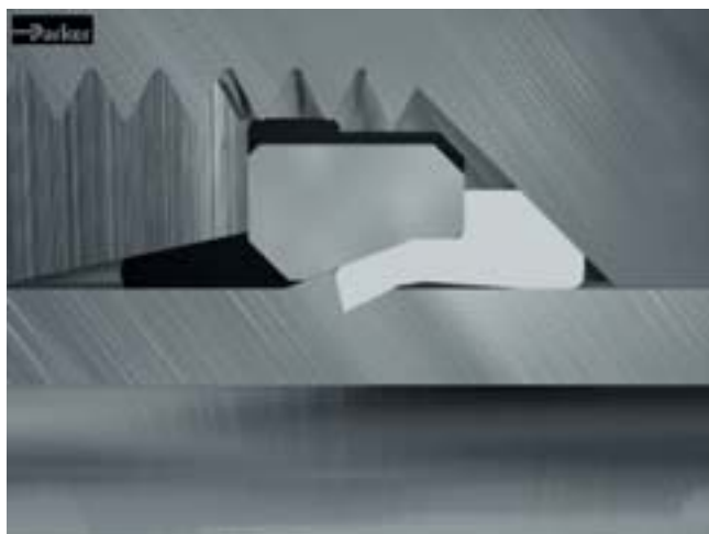
Dopo il serraggio del tubo
