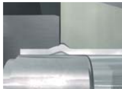
Anche il contorno interno si deforma leggermente ma resta liscio e non si restringe per consentire buone caratteristiche di flusso
