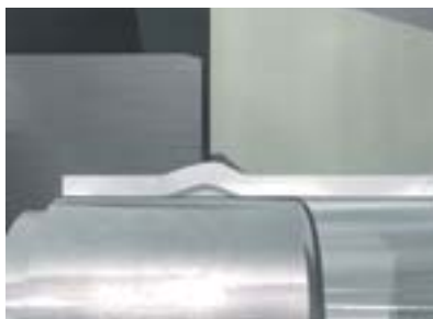
La forma dell'utensile definisce il contorno esterno della parete del tubo formato
